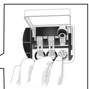
② インク注入口にガスケットを取り付けます。
