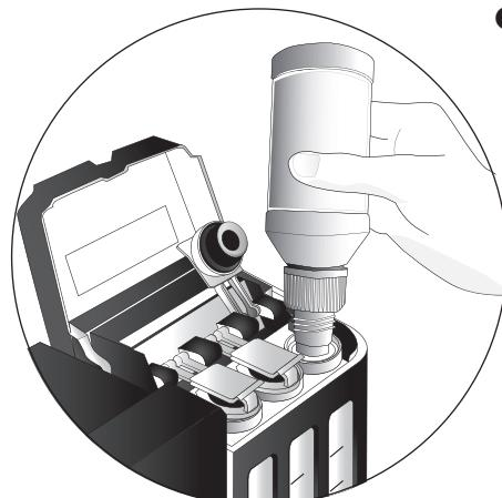
③ インクボトルのノズルキャップを外し、ガスケットを取り付けたインク注入口にノズルを差し込んでタンクの上限線までインクを注入します。
