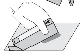
インク出口を下に向け、インク出口から少し上のカートリッジの腹をつまんで、余分なインクをインク出口から絞り出します。インク出口を下に向けたまま2、3分放置します。
