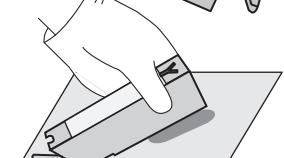
インク出口を下に向け、インク出口から少し上のカートリッジの腹をつまんで、余分なインクをインク出口から絞り出します。インク出口を下に向けたまま2、3分放置します。
