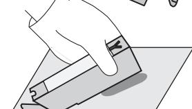
インク出口を下に向け、インク出口から少し上のカートリッジの腹をつまんで、余分なインクをインク出口から絞り出します。インク出口を下に向けたまま2、3分放置します。
