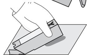
インク出口を下に向け、インク出口から少し上のカートリッジの腹をつまんで、余分なインクをインク出口から絞り出します。インク出口を下に向けたまま2、3分放置します。インクが垂れないことを確認し、プリンタに取り付けます。
